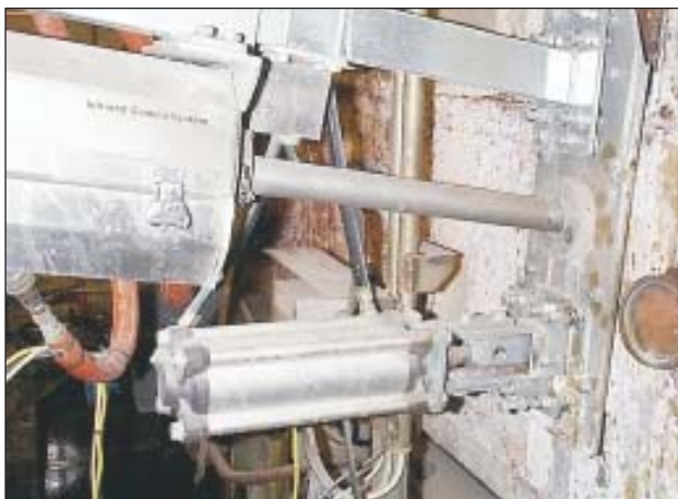
Установка CAMROD для очистки канала для камеры наблюдения слоя IR.
